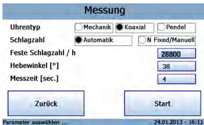
Dans l'écran « Mesure », appuyez sur le type de montre « Coaxial ». Saisissez les informations dans les zones Alternance, Alternance fixe, Angle de levée et Durée de mesure.
