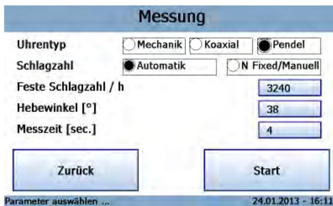
Dans l'écran « Mesure », appuyez sur le type de montre « Pendule ». Saisissez les informations dans les zones Alternance, Alternance fixe, Angle de levée et Durée de mesure.
